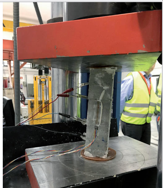
RESISTIVITÀ ELETTRICA FRAZIONALE (FCR) DI UN CALCESTRUZZO CHE CONTIENE NANOTUBI E MICROFIBRE DI CARBONIO, MISURATA DURANTE CICLI DI FATICA MECCANICA (LOAD) PRESSO L'ISTITUTO EDUARDO TORROJA IN SPAGNA THE FRACTIONAL CHANGE IN RESISTIVITY (FCR) OF A CONCRETE CONTAINING CARBON NANOTUBES AND MICROFIBERS MEASURED DURING MECHANICAL FATIGUE CYCLES (LOAD) AT THE EDUARDO TORROJA INSTITUTE IN SPAIN
